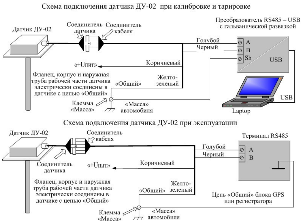
Рис. 2. Схемы подключения датчика ДУ-02 в режимах калибровки, тарировки и штатной работы (при эксплуатации).
