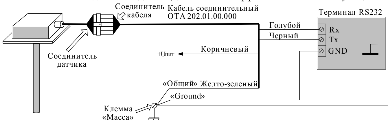
Рис. 3. Схемы подключения датчиков ДУ-02S в режиме штатной работы (при эксплуатации).
