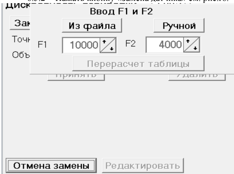
Рис. 18 Фрагмент окна «Тарировка» после нажатия кнопки «Замена датчика»
