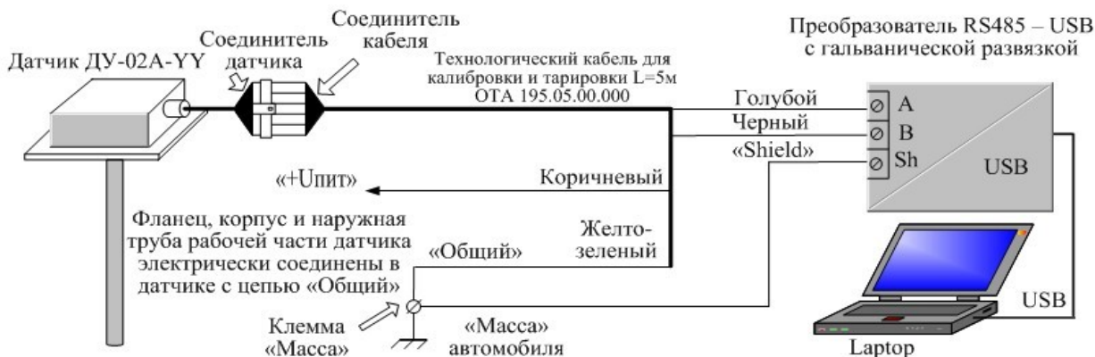
Схема подключения датчика ДУ-02А-УУ при калибровке и тарировке
