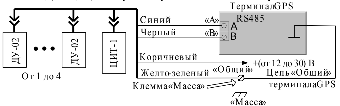
Рис. 2. Схема подключения ДУ-02, ЦИТ-1 при эксплуатации совместно с терминалом GPS.
