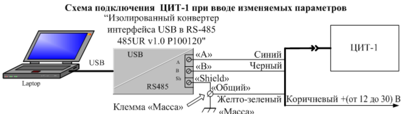
Рис. 4. Схема подключения ЦИТ-1 при вводе изменяемых параметров
