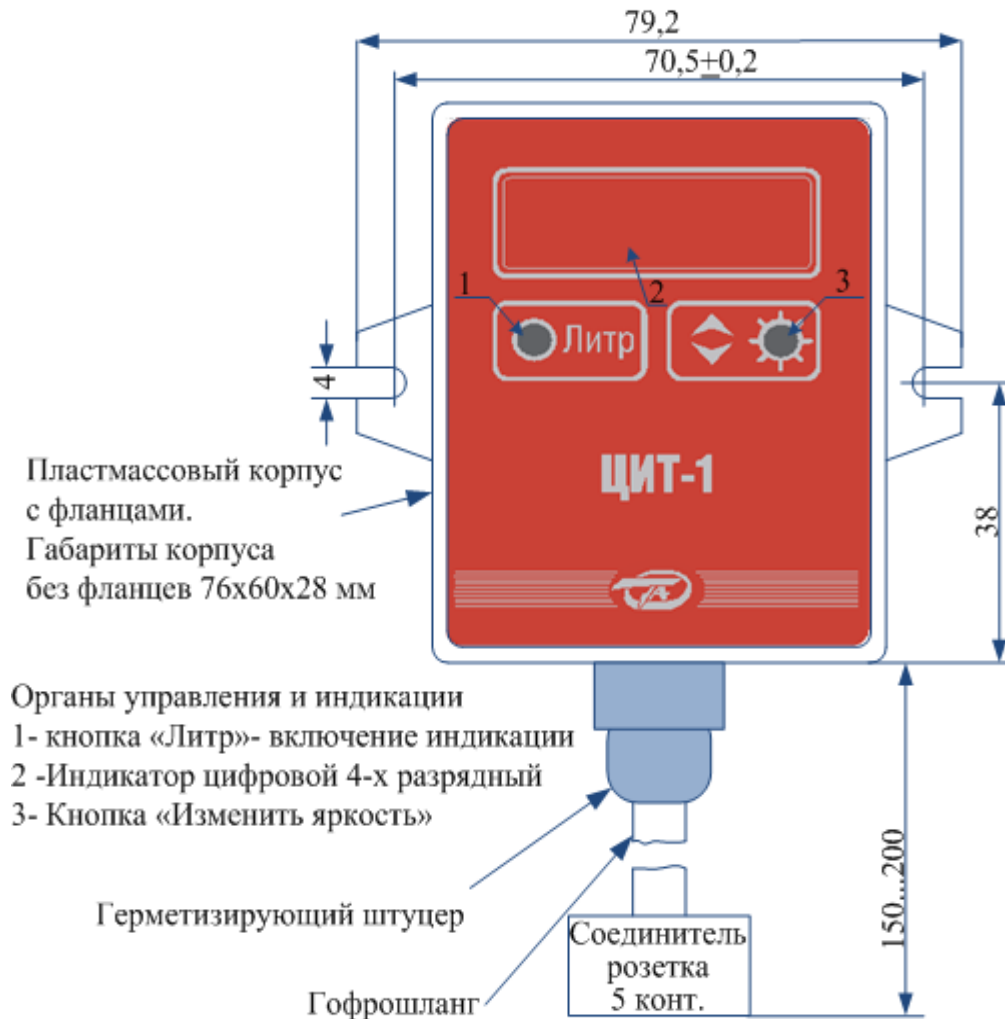
Рис. 1. Внешний вид, габаритные и присоединительные размеры ЦИТ-1
